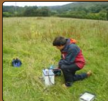
Tomografía eléctrica, detección de metales (EM-61) y sísmica de refracción
