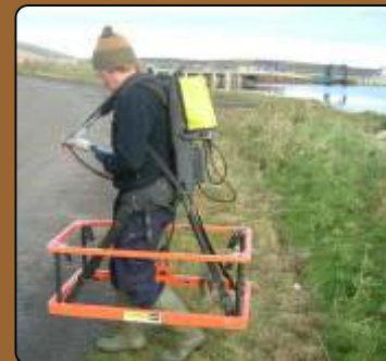
Tomografía eléctrica, detección de metales (EM-61) y sísmica de refracción
