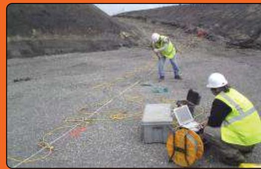
Estudios de sismica de refracción y conductividad del terreno
