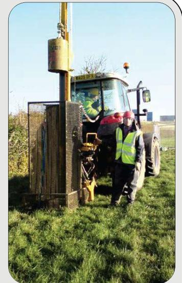
Fuente sísmica mediante caída de peso
