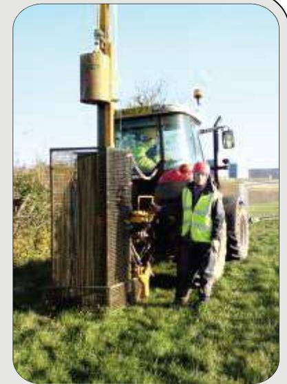
Fuente sísmica mediante caída de peso
