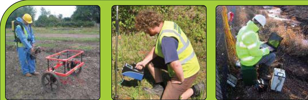
Detección de metales, análisis de vapores y tomografía de resistividad
